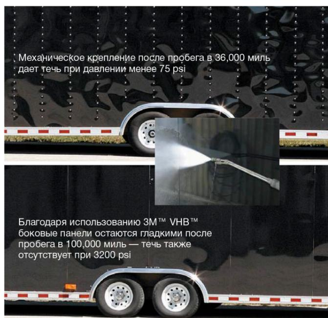
Механическое крепление после пробега в 36,000 миль дает течь при давлении менее 75 psi
